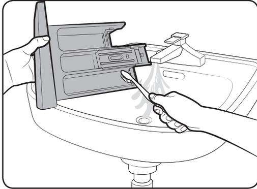
3. reinigen Sie die Schubladenteile unter fließendem Wasser und mit einer weichen Bürste.
