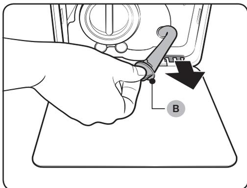
3. Legen Sie die Abdeckung in einen leeren, geräumigen Behälter und ziehen Sie den Abflussschlauch zum Behälter, während Sie die **Röhrenkappe (B)** halten.
