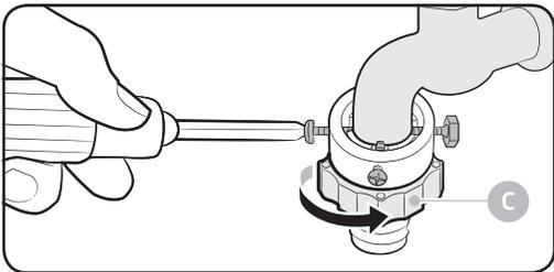
4. Führen Sie den Adapter in den Wasseranschluss ein und ziehen Sie die Schrauben fest, während Sie den Adapter anheben.
