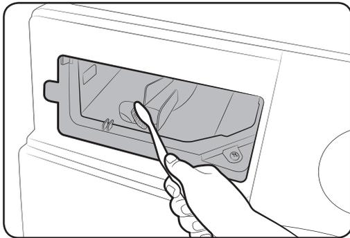
4. Reinigen Sie den Einschub mit einer weichen Bürste.
