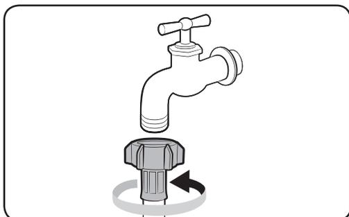
7. Wenn Sie einen Wasserhahn mit Schraubklemmen verwenden, nutzen Sie den mitgelieferten Adapter mit Schraubklemmen, um den Wasserhahn wie gezeigt anzuschließen.
