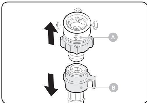
Schließen Sie den Zuwasserschlauch am Wasseranschluss an.
