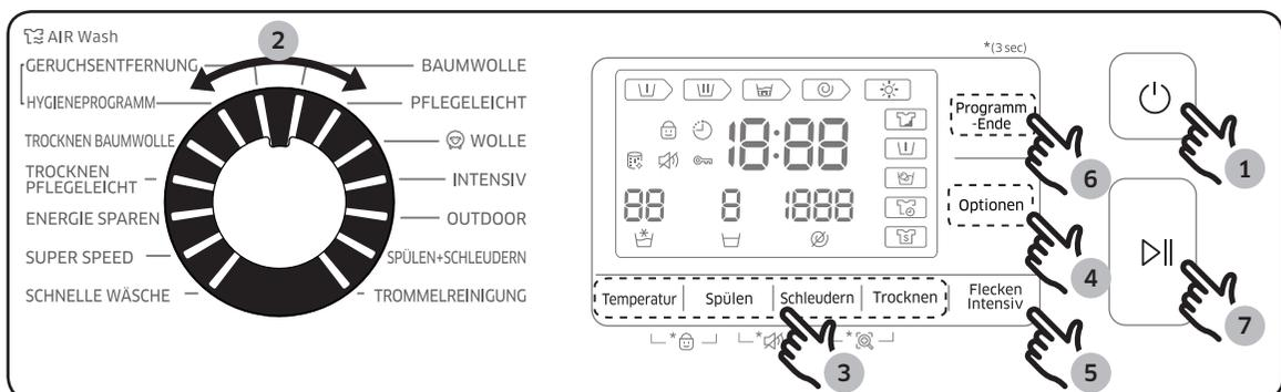
1. Drücken Sie die **Ein/Aus-Taste** der Waschmaschine.
