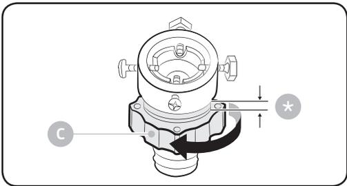
3. Halten Sie den Adapter fest und drehen Sie Teil (C) in Pfeilrichtung, um es um 5 mm zu lösen (\*).
