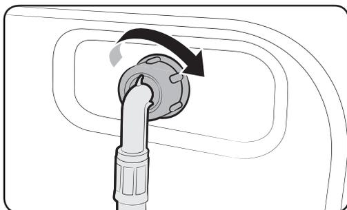
8. Verbinden Sie das andere Ende des Zuwasserschlauchs mit dem Eintrittsventil auf der Rückseite der Waschmaschine. Drehen Sie den Schlauch im Uhrzeigersinn, um ihn festzuziehen.
