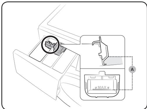
Stecken Sie zunächst den Flüssigwaschmittelbehälter in das **II** Waschlappenschubladenmechanismus ein. Füllen Sie dann Flüssigwaschmittel bis unter die **Maximallinie (A)** in den Behälter ein.
