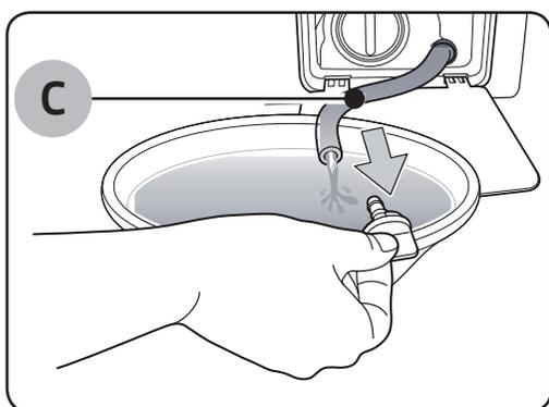
4. Öffnen Sie die Röhrenkappe und lassen Sie das Wasser im **Schlauch (C)** in den Behälter fließen.
