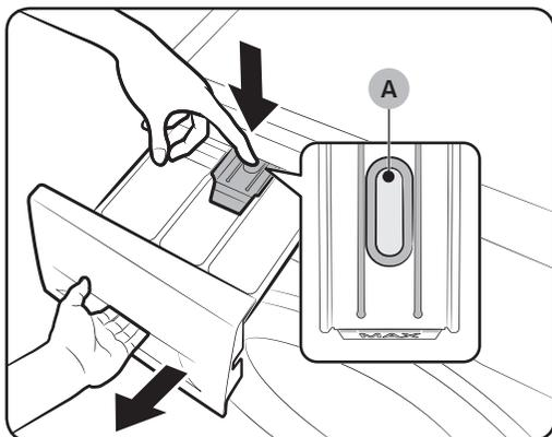
1. Während Sie den **Entriegelungshebel (A)** auf der Innenseite des Waschmittelbehälter herunterdrücken, schieben Sie den Waschmittelbehälter auf.
