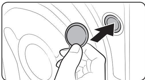
**23.** Verschließen Sie die Transportsicherungsöffnungen mit den mitgelieferten Kunststoffabdeckungen. Bewahren Sie die Transportsicherungen für einen späteren Gebrauch auf.
