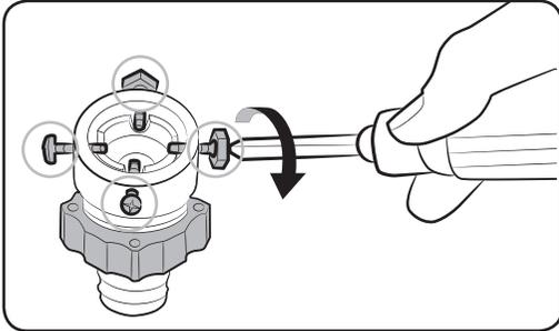
2. Lösen Sie die vier Schrauben am Adapter mithilfe eines Philips-Schraubenziehers.
