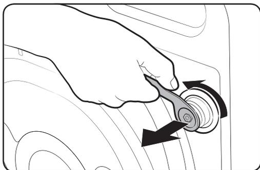
Die Produktverpackung auspacken und alle Transportsicherungen entfernen.
