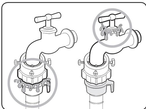
9. Öffnen Sie den Wasseranschluss und überprüfen Sie, ob sich Lecks um die Anschlussbereich herum befinden. Tritt an einer dieser Stellen Wasser aus, so wiederholen Sie die genannten Schritte.
